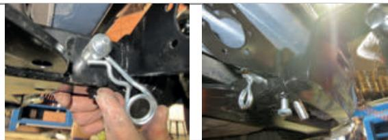
**ШАГ 5.** Установите съемный шар в сборе и закрепите его пальцем гнутым гальванизированным со шплином пружинным игольчатым. Затяните шар ключом на 38 мм. Установите фиксирующий болт M10x20 снизу, он используется для исключения технологических люфтов съемного шара и только в ненагруженном состоянии! Перед сцепкой болт демонтиrovать!
