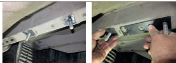
**ШАГ 3.** Установите балку ТСУ, совместив отверстия в боковых кронштейнах и в балке. Закрепите балку ТСУ с помощью болтов M10x1,25x30 через шайбы 10 и шайбы 10 гроверные гайками M10x1,25. Отрегулируйте положение балки ТСУ и затяните все резьбовые соединения.
