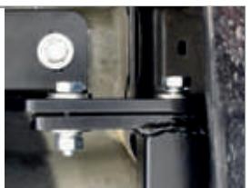
**ШАГ 5.** Затяните все резьбовые соединения. Закрепите кронштейн розетки гайкой M10 через шайбу 10 увеличенную и шайбу 10 гроверную. Установите съёмный шар в сборе и закрепите его пальцем гнутым со шплинтом. Зафиксируйте съёмный шар винтом M10x20 снизу. Затяните шар с помощью ключа рожкового или головки на 38мм.
