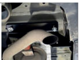
**ШАГ 4.** Для установки балки ТСУ совместите отверстия в балке ТСУ с отверстиями кронштейнов и соедините всё болтами M10x1,25x40 через шайбы 10, гайками M10x1,25.
