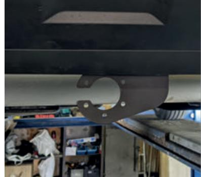
**ШАГ 5.** Установите фиксирующий болт M10x20 снизу, он используется для исключения технологических люфтов съемного шара и только в ненагруженном состоянии! Перед сцепкой болт демонтировать! Установка завершена.
