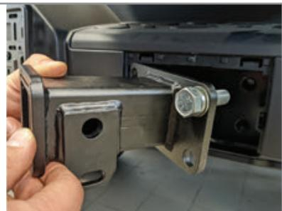
**ШАГ 3.** Отрегулируйте положение балки ТСУ относительно задней поперечины рамы и затяните все соединения.
