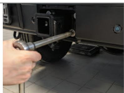
**ШАГ 4.** Открутите штатный винт крепления бампера к кронштейну с левой стороны бампера. Установите кронштейн розетки, закрепите его тем же штатным болтом.
