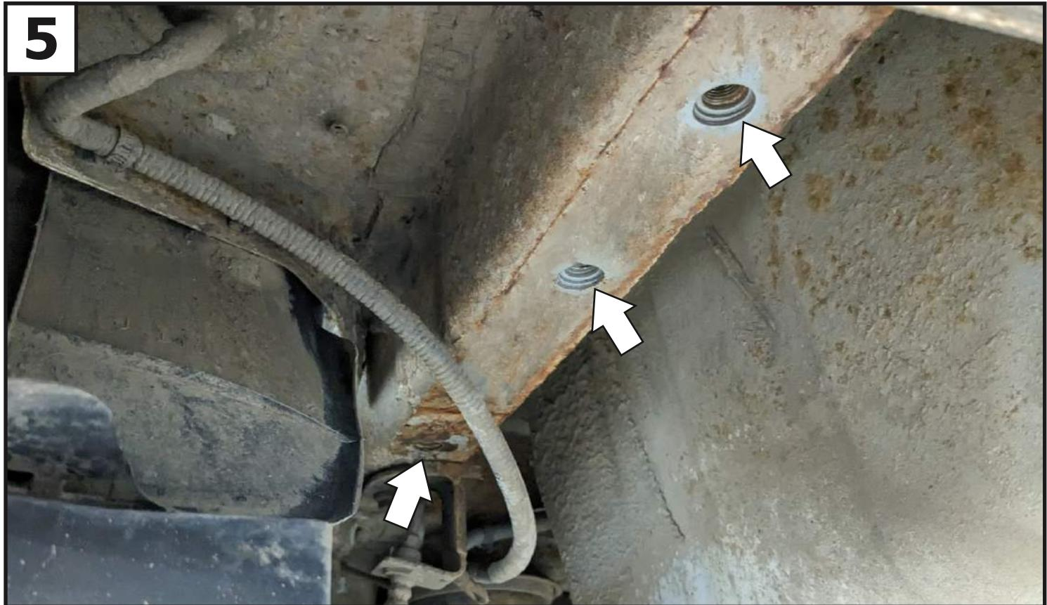
Установить левый кронштейн (3) совместно со штатной буксировочной петлей (при ее наличии), закрепив их к лонжерону автомобиля в штатные отверстия с резьбой M12x1,25 при помощи болтов M12x1,25x45 (8), болта M12x1,25x40 (7), шайб 12 пружинных (12) и шайб 12 увел. (13).
