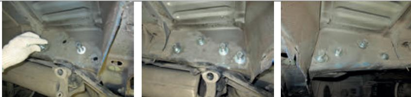
**ШАГ 3.** Установите балку ТСУ, совместив отверстия в закладных и в балке ТСУ. Соедините их с помощью болтов М10х1,25х40 через шайбы 10 гроверные и шайбы 10 увеличенные, гайками М10х1,25. Затяните все соединения.
