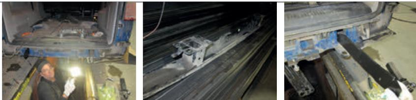
**ШАГ 2.** Совместите отверстия в закладных пластинах и в лонжеронах автомобиля. Наживите закладные пластины болтами М10х1,25х40 к лонжеронам автомобиля через шайбы 10 гроверные и шайбы 10 увеличенные. Соединения не затягивайте.
